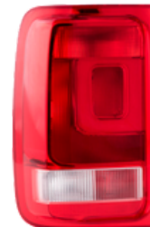
Amarok 2013-> Faro Trasero (Modelo Cibié) 33072D LD - Bicolor FT8054 33072E LE - Bicolor FT8016 Lente PMMA - Carcaza ABS + PC
