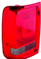
Amarok 2010-> Faro Trasero (Modelo Arteb) 33070FD LD - Fume FT8055 33070FE LE - Fume FT8062 Lente PMMA - Carcaza ABS + PC
