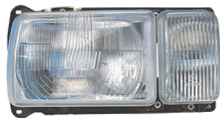
FARO H4 CON AUXILIAR H3
