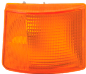
Señalero Delantero Direccional Marcopolo AMBAR Cod: 335.110 LD SI46003
