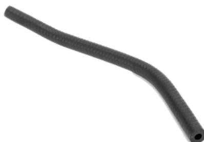
RESERVORIO AL RADIADOR Gol/Voyage/Parati/Saveiro 89>96
